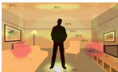
Радиаторные системы отопления обогревают помещение за счет конвекции, и дают значительный разброс температур воздуха по высоте и площади помещения. При этом температура поверхности пола всегда ниже минимальной комфортной.
